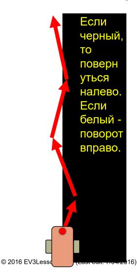
Робот должен выбрать куда поворачиваться при разных цветах.
