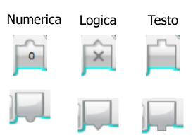
Utilizzate le caselle in alto per identificare se la variabile ha input o output e se e numerica logica o di testo
